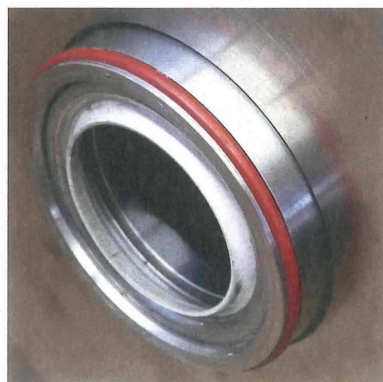
Die Wellenabdichtung wurde über eine einfach zu demontierende Dichtungspatrone realisiert.
